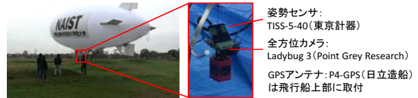
(a) 無人飛行船と搭載機器の外観
